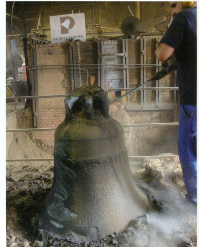
Der Glockenmantel aus Lehm wird behutsam entfernt, Glocke Hl. Florian, Pfarrkirche Pötting, Foto: Andrea Auer
