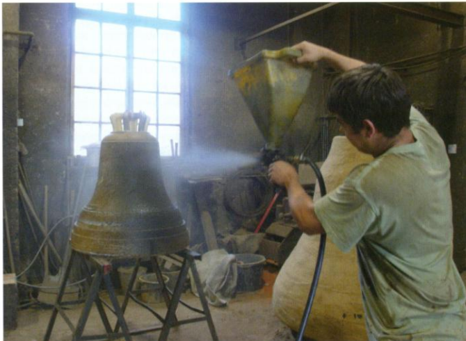
Aufbringung von Fett und Graphit als Trennschicht auf die falsche Glocke, Foto: Andrea Auer
